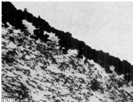
Abb. 12. Elektronenmikroskopische Aufnahme eines Querschliffs der Grenzfläche ABS-Metall (nach [13], Vergrößerung 9250-mal).
